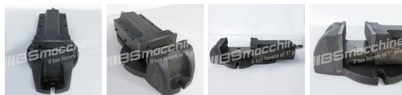
Morsa a macchina con ganascia dentata usata, ideale per essere utilizzata su fresatrice, trapano.
