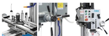
Il **trapano fresa ad ingranaggi FERVI T047/400V**, è una macchina utensile progettata per eseguire semplici operazioni, quali: **foratura, fresatura**.
